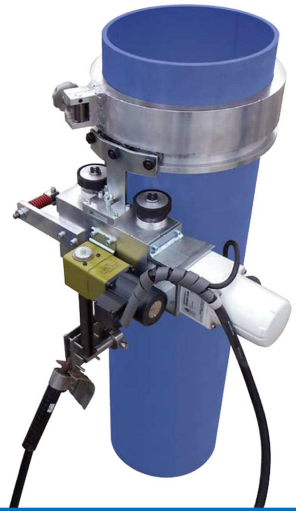
ECS-AW (現場自動溶接ロボット工法)
